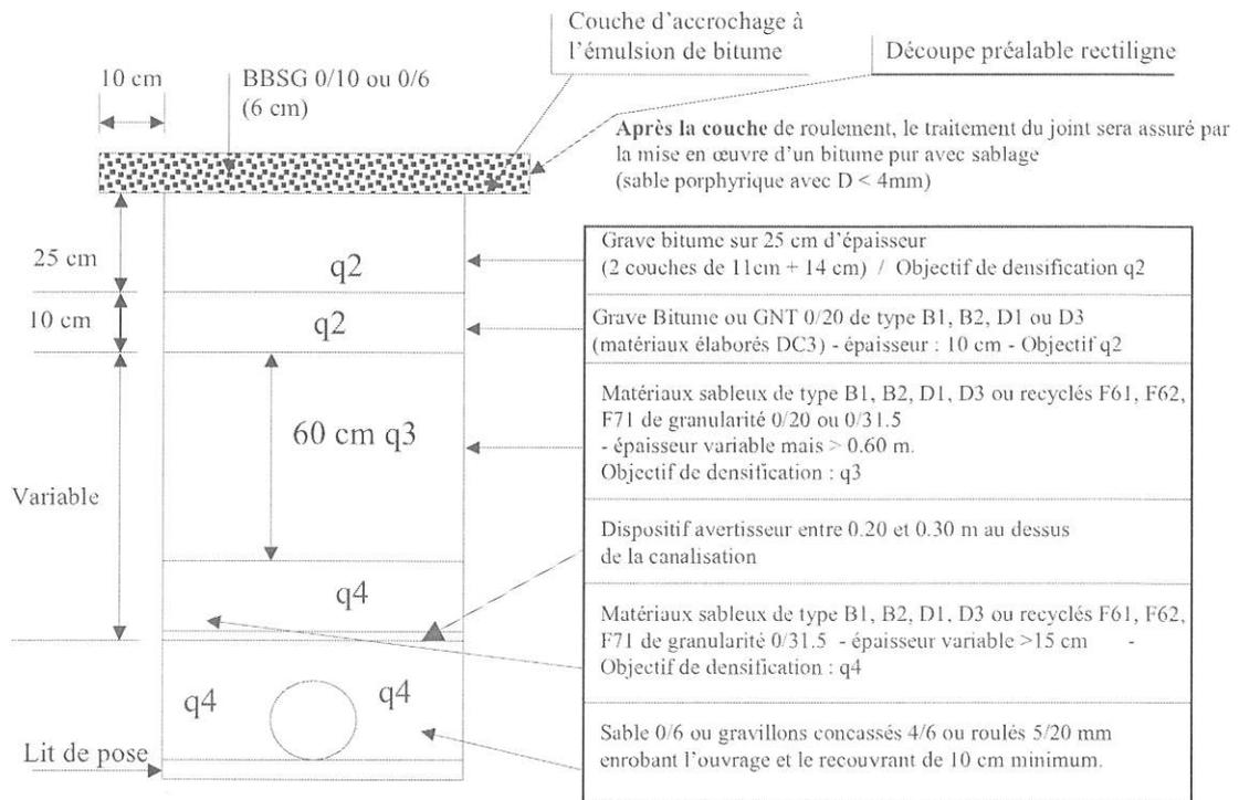
**Avant la réalisation de la couche de roulement**, une découpe sera réalisée à 10 cm de la première coupe pour croisement de cette dernière surface avec l'enrobé existant. Une liaison par arrosage à l'émulsion de bitume sera réalisée pour collage de ces surfaces. Si la partie inférieure de remblai est inférieure à 15 cm, alors elle est intégrée entièrement à la PSR avec un objectif de densification q3.
