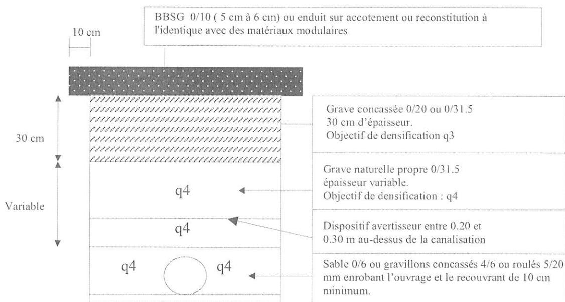
Si la tranchée ne peut être implantée à une distance au moins égale à sa profondeur (distance du bord de chaussée), la partie inférieure de remblai sera réalisée avec un compactage dont l'objectif de densification est q3 pour les 60 cm supérieurs de remblai. Au delà de 60 cm, l'objectif de compactage est q4 avec réemploi possible des matériaux en place.
