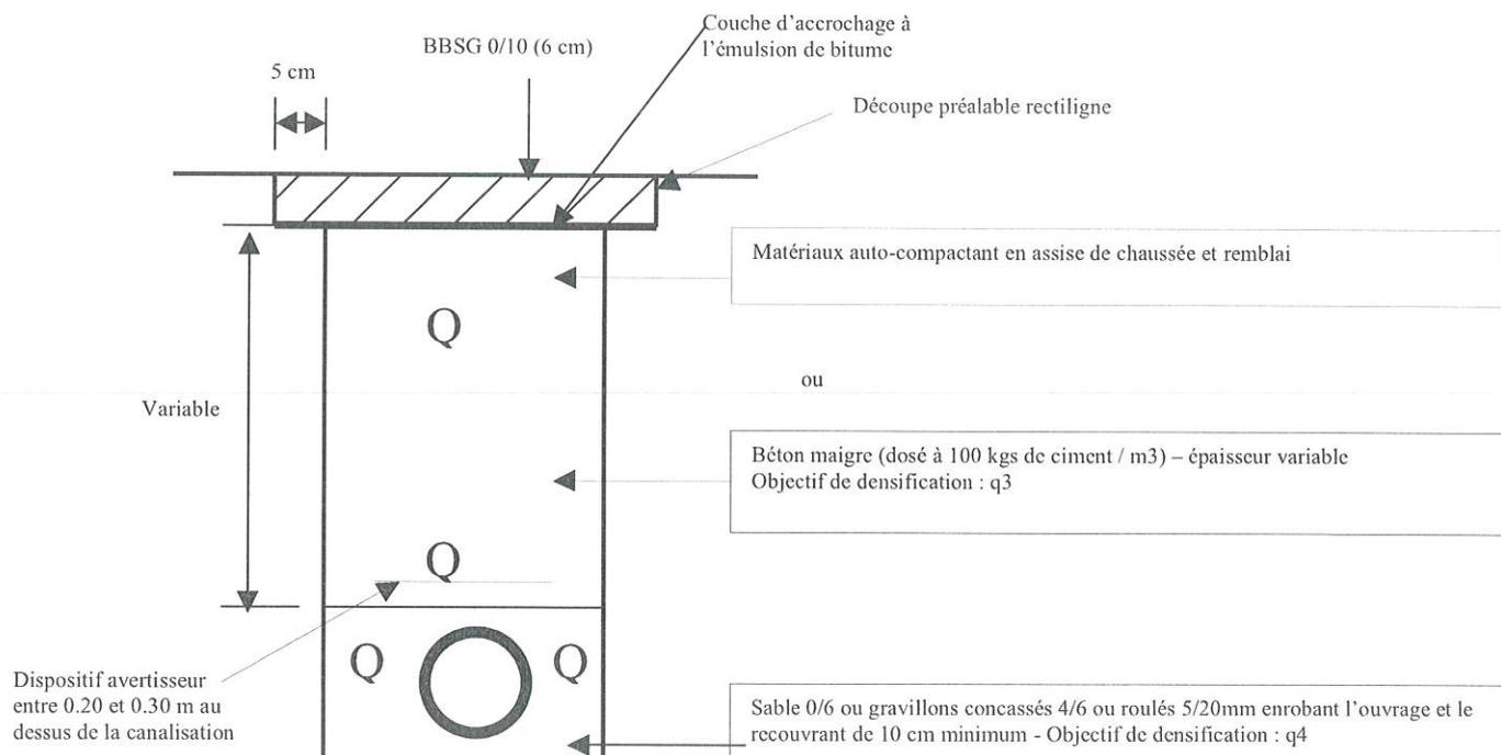
Avant la réalisation de la couche de roulement, une découpe sera réalisée à 10 cm de la première coupe pour croisement de cette dernière surface avec l'enrobé existant.
