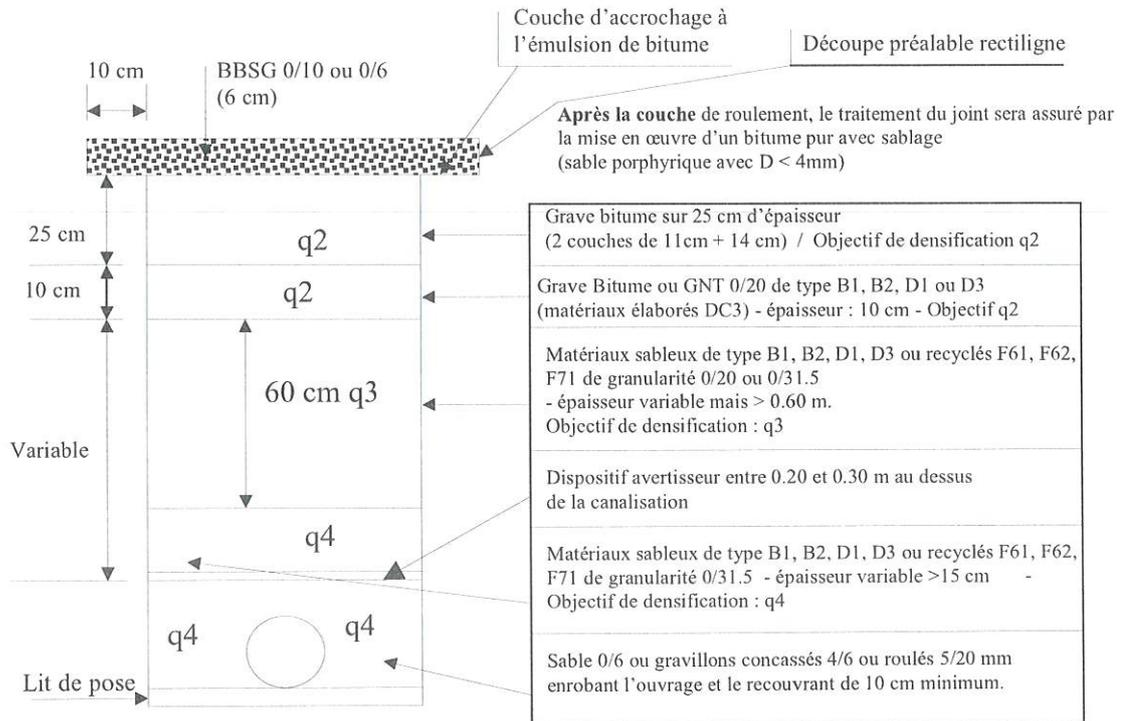
**Avant la réalisation de la couche de roulement**, une découpe sera réalisée à 10 cm de la première coupe pour croisement de cette dernière surface avec l'enrobé existant.
