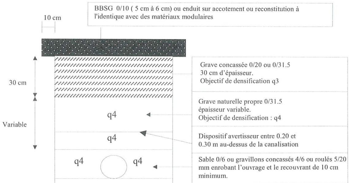
Si la tranchée ne peut être implantée à une distance au moins égale à sa profondeur (distance du bord de chaussée), la partie inférieure de remblai sera réalisée avec un compactage dont l'objectif de densification est q3 pour les 60 cm supérieurs de remblai.
