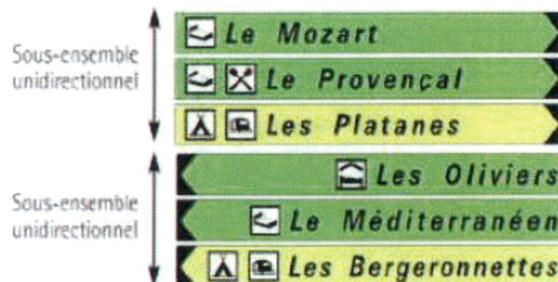
Les panneaux constituant un sous-ensemble unidirectionnel ont des longueurs identiques et sont alignés verticalement.
