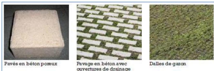
Annexe 19: Exemple de matériaux contribuant à rendre la chaussée poreuse
