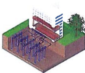
Pompe à chaleur sur sondes géothermiques
