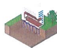
Pompe à chaleur sur géostructures énergétiques
