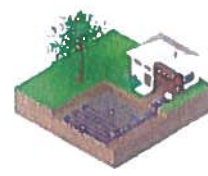
Pompe à chaleur sur capteurs enterrés horizontaux
